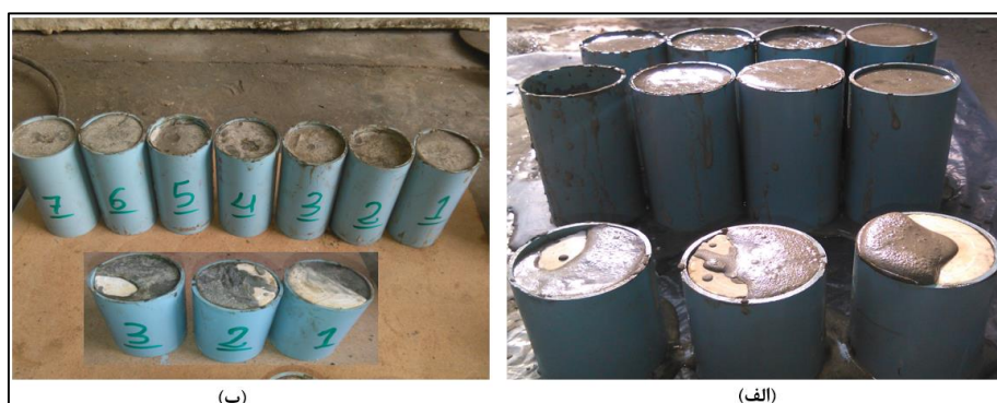
شکل ۴-۱۱: نمونه‌های سیمان قبل از گیرش (الف) و بعد از ۲۸ روز (ب) درون قالب
