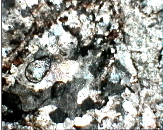
شکل ۳-۷- عکس گرفته شده از مقطع نازک تهیه شده از تراورتن قرمز
