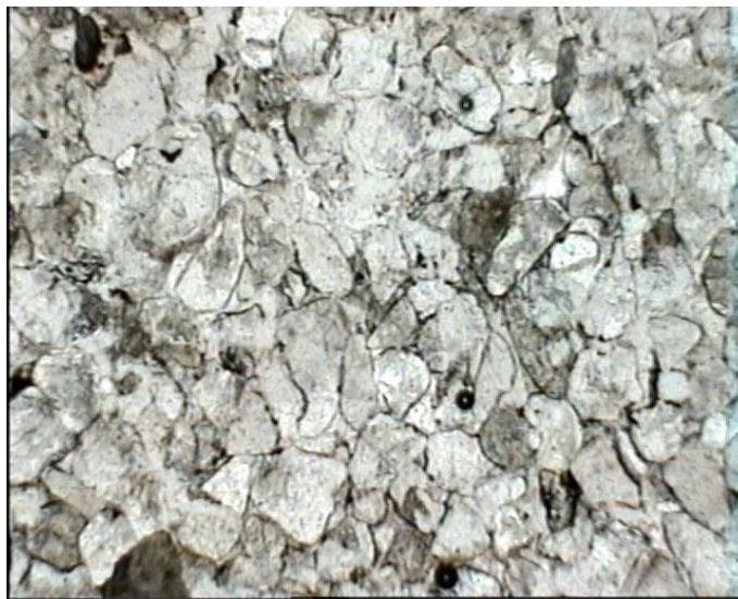
شکل ۳-۸- عکس گرفته شده از مقطع نازک تهیه شده از سیلیس
