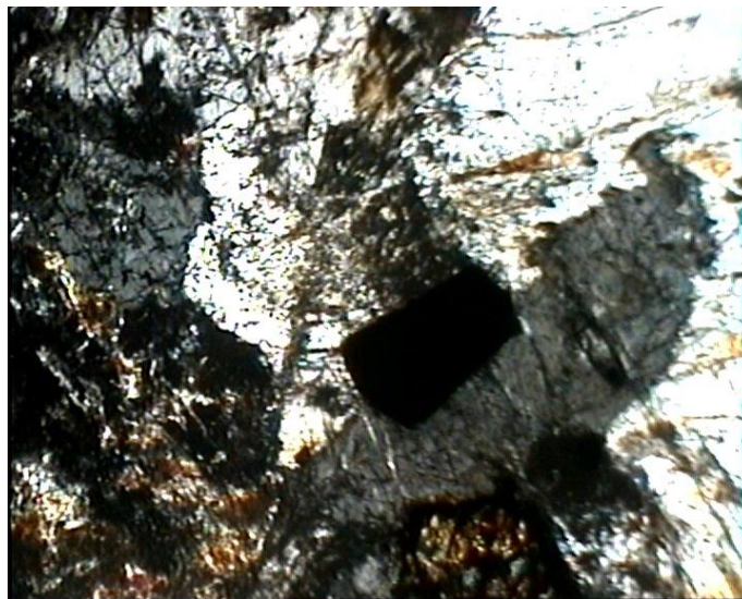
شکل ۳-۹- عکس گرفته شده از مقطع نازک تهیه شده از نفلین سینیت
