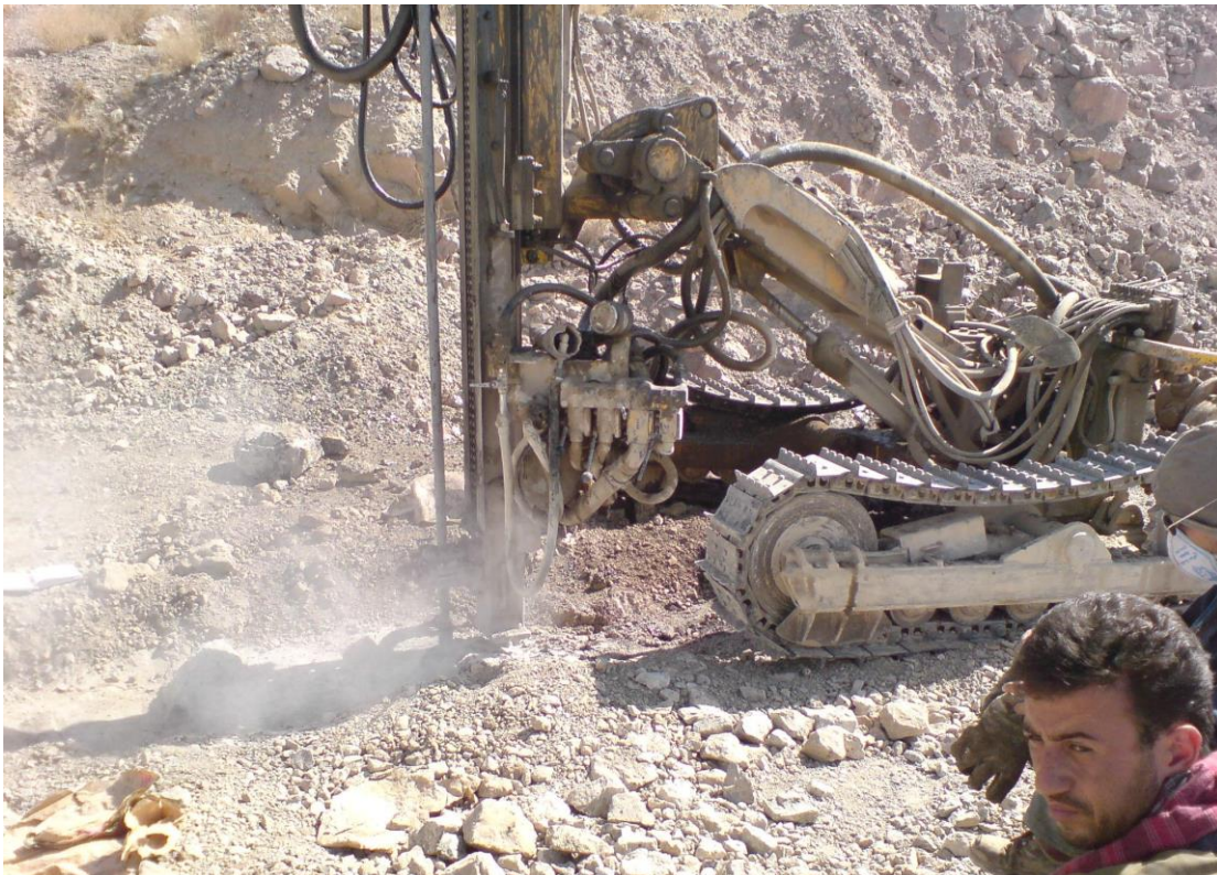
شکل ۳-۱۴ - دستگاه حفاری ضربه‌ای-دورانی مورد استفاده در مطالعات در حین حفر چال در نمونه‌ها
