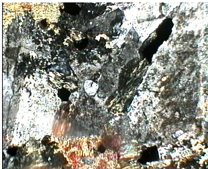
شکل ۳-۳- عکس گرفته شده از مقطع نازک تهیه شده از گرانیت مراغه
