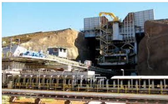
شکل ۴-۳- سیستم سنگ شکن نیمه متحرک و نوار نقاله
