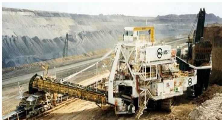
شکل ۴-۴- سیستم سنگ شکن متحرک و نوار نقاله
