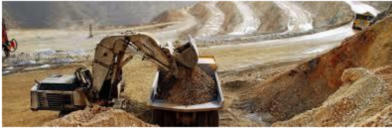
شکل ۴-۱- سیستم شاول هیدرولیکی و کامیون
