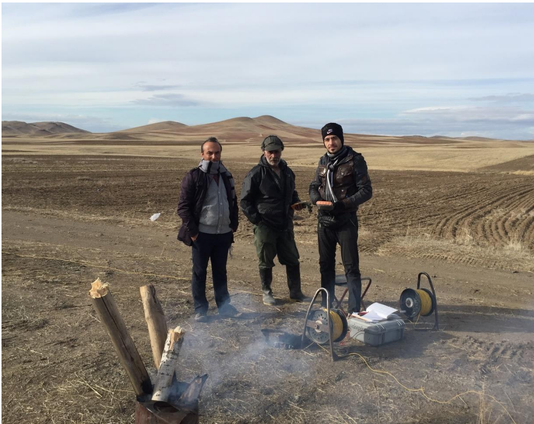
شکل ۴-۷: عملیات برداشت داده‌های مقاومت ویژه و IP در امتداد یکی از پروفیل‌های برداشت، تجهیزات و دستگاه فرستنده (سمت راست تصویر)، و توپوگرافی نسبتاً هموار محدوده (دید به سمت جنوب شرق).
