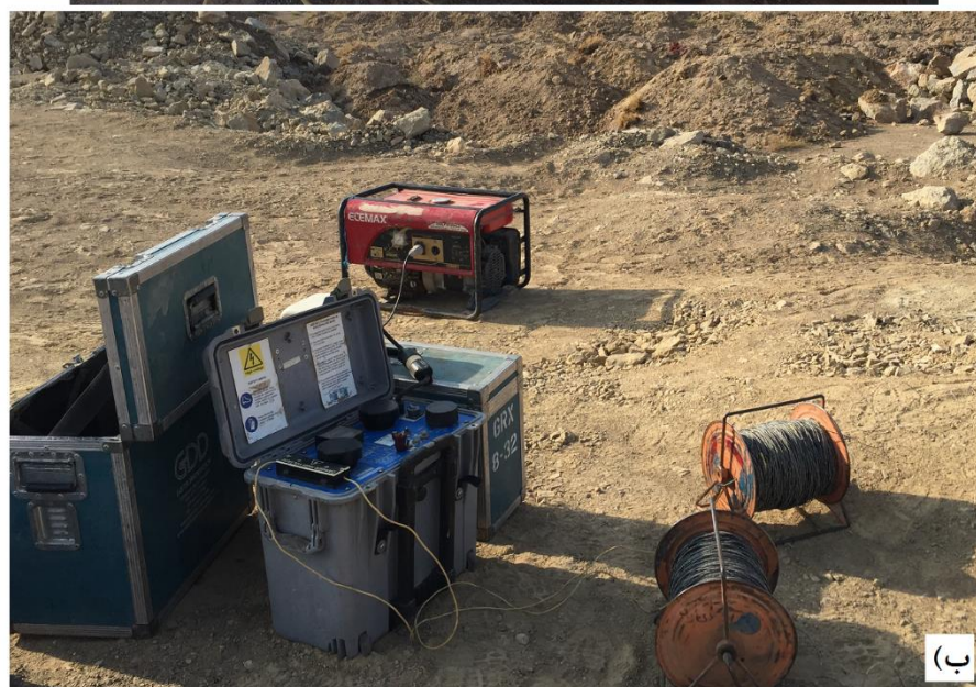
شکل ۴-۴: تجهیزات و وسایل ارسال جریان؛ الف) دستگاه فرستنده جریان TXIII؛ ب) ژنراتور، دستگاه فرستنده جریان و قرقره‌های کابل‌های انتقال جریان
