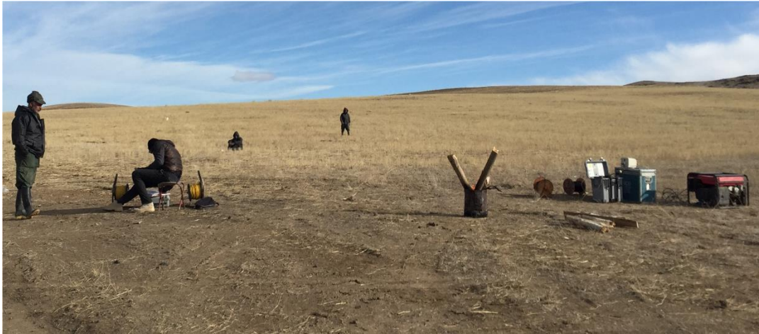
شکل ۴-۷: عملیات برداشت داده‌های مقاومت ویژه و IP در امتداد یکی از پروفیل‌های برداشت، تجهیزات و دستگاه فرستنده (سمت راست تصویر)، و توپوگرافی نسبتاً هموار محدوده (دید به سمت جنوب شرق).
