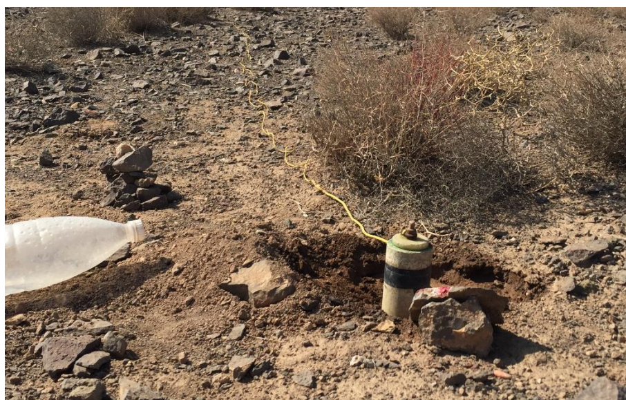
شکل ۴-۶: تصویر الکتروده غیرپلاریزه پتانسیل بر روی یکی از نقاط برداشت.
