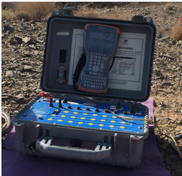
شکل ۴-۵: دستگاه گیرنده GRx8-32 به همراه نمایشگر دستی.
