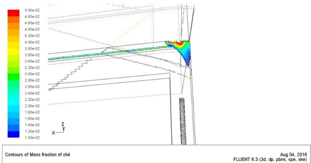
شکل (۴-۱۴): میزان غلظت گاز متان در انتهای کارگاه استخراج با محدوده ۱ تا ۵ درصد
