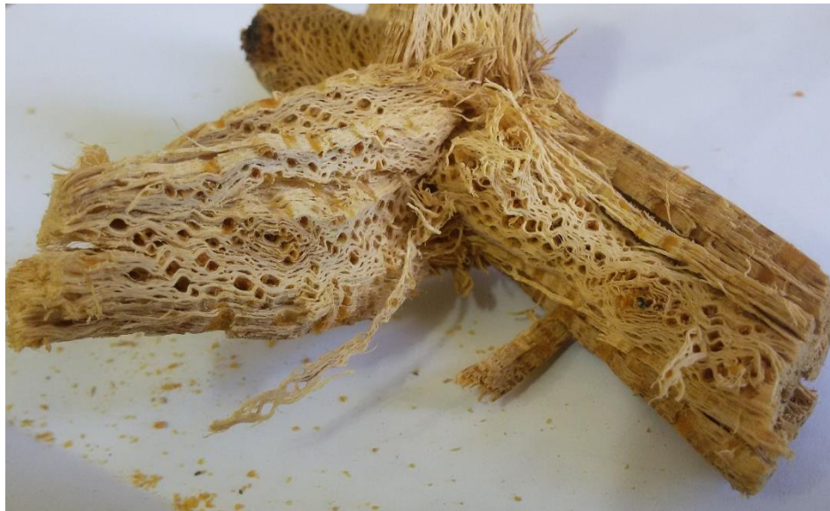
شکل ۳-۸: گون خشک‌شده در دمای ۱۲۰ درجه سانتی‌گراد و مشاهده تخلخل بالای آن.
