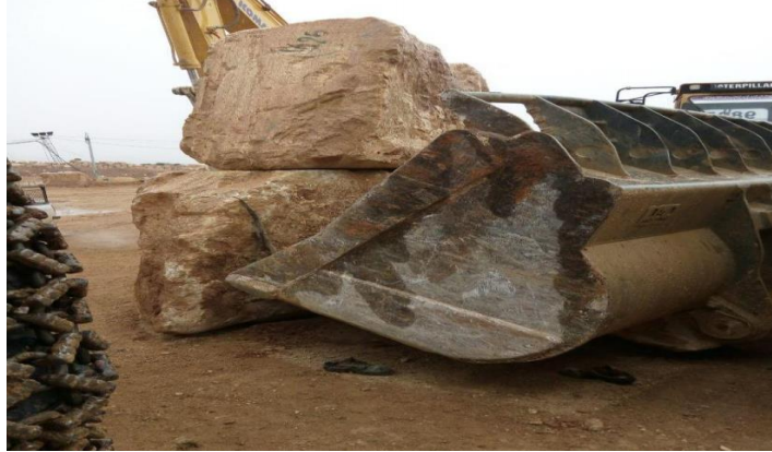
شکل ۳-۶: سقوط بیل روی تعمیرکار و اپراتور [۱۱۱]
