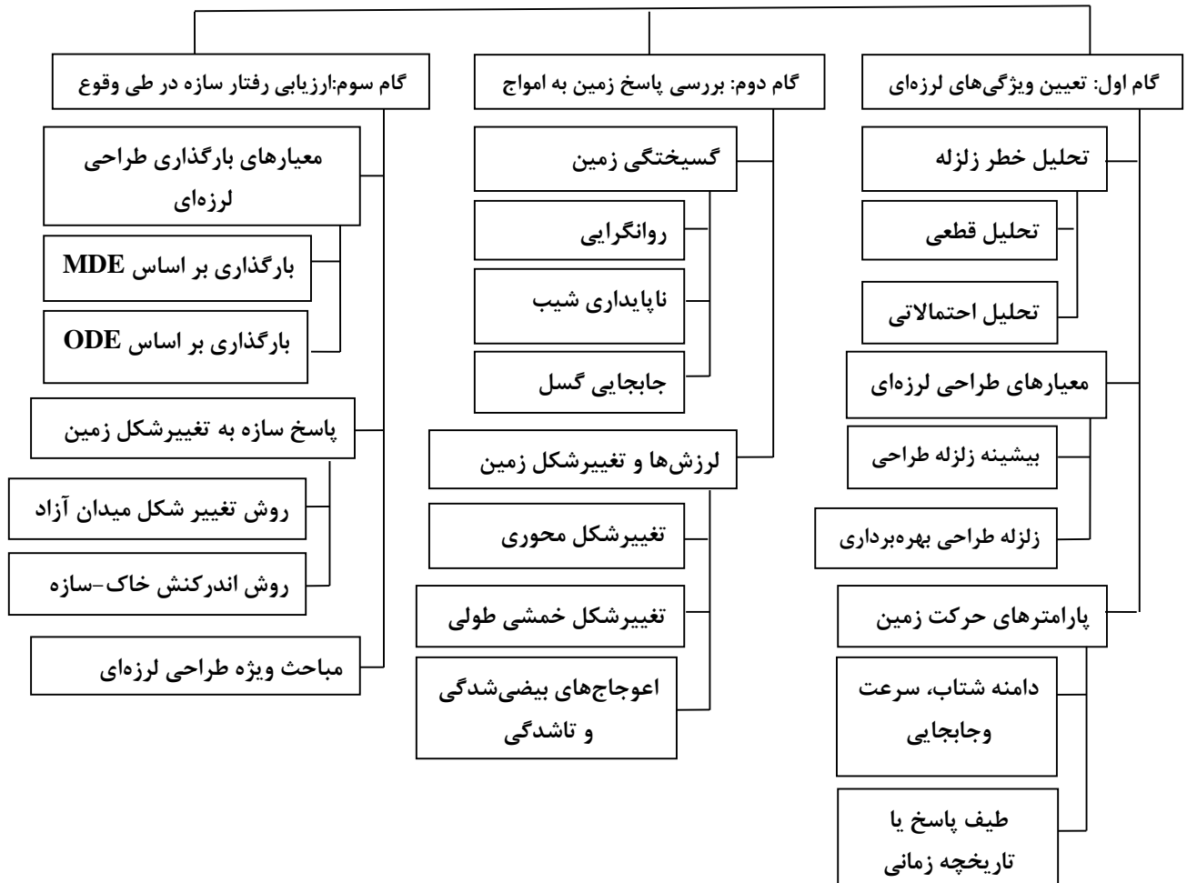
شکل ۲-۴- روش تحلیل و طراحی دینامیکی فضاهاى زیرزمینی (Hashash et al, 2001)
