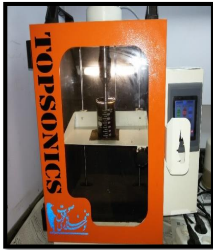
شکل ۳-۲۴- نحوه قرارگیری نمونه داخل دستگاه آلتراسونیک.
