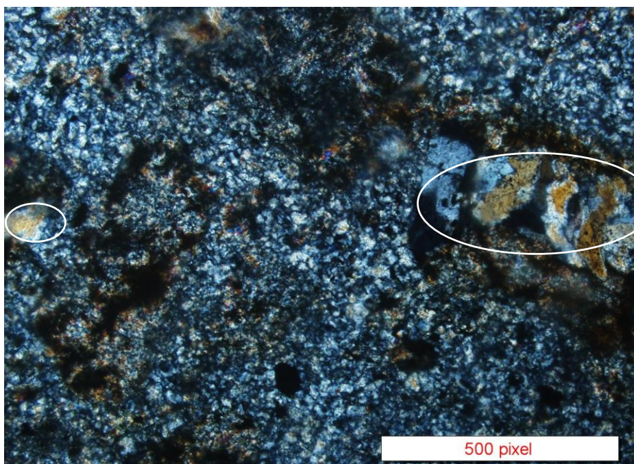
شکل ۲-۳: همراهی کانی‌های کوارتز خاکستری و دولومیت در نمونه‌های کانسنگ چاهداشی (مقاطع نازک)
