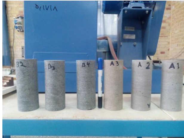
شکل ۳-۹: مغزه‌های آماده‌سازی شده بر اساس استاندارد ISRM .
