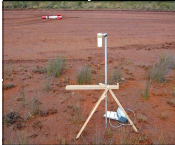
شکل (۲-۷) نمونه‌ای از دستگاه مغناطیس‌سنج در حین برداشت داده در ایستگاه مبنا [۲۸].
