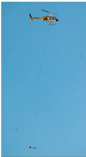
شکل (۲-۴) نمونه‌ای از برداشت هوابرد مغناطیس به صورت معلق [۲۸].
