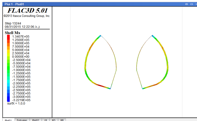
شکل ۶-۴۷- نیروی محوری وارد بر پوشش اولیه، گالری چپ (روباره ۱۳)
