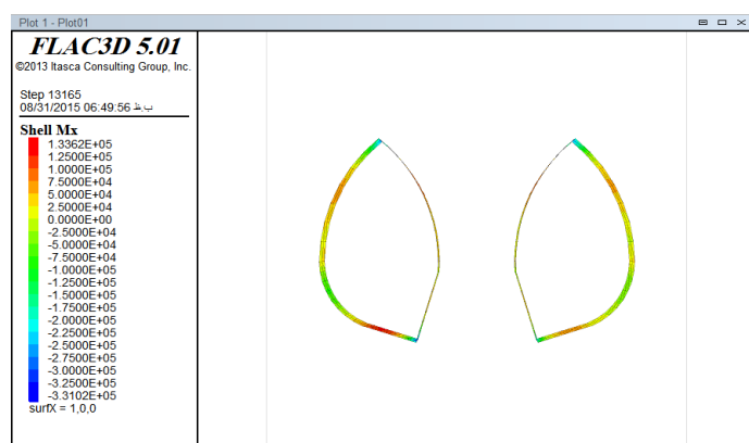
شکل ۶-۵۳- گشتاور خمشی وارد بر پوشش اولیه، گالری راست و چپ (روباره ۸)
