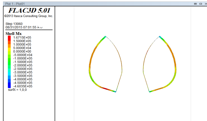
شکل ۶-۵۸- گشتاور خمشی وارد بر پوشش اولیه، گالری راست و چپ (روباره ۴)
