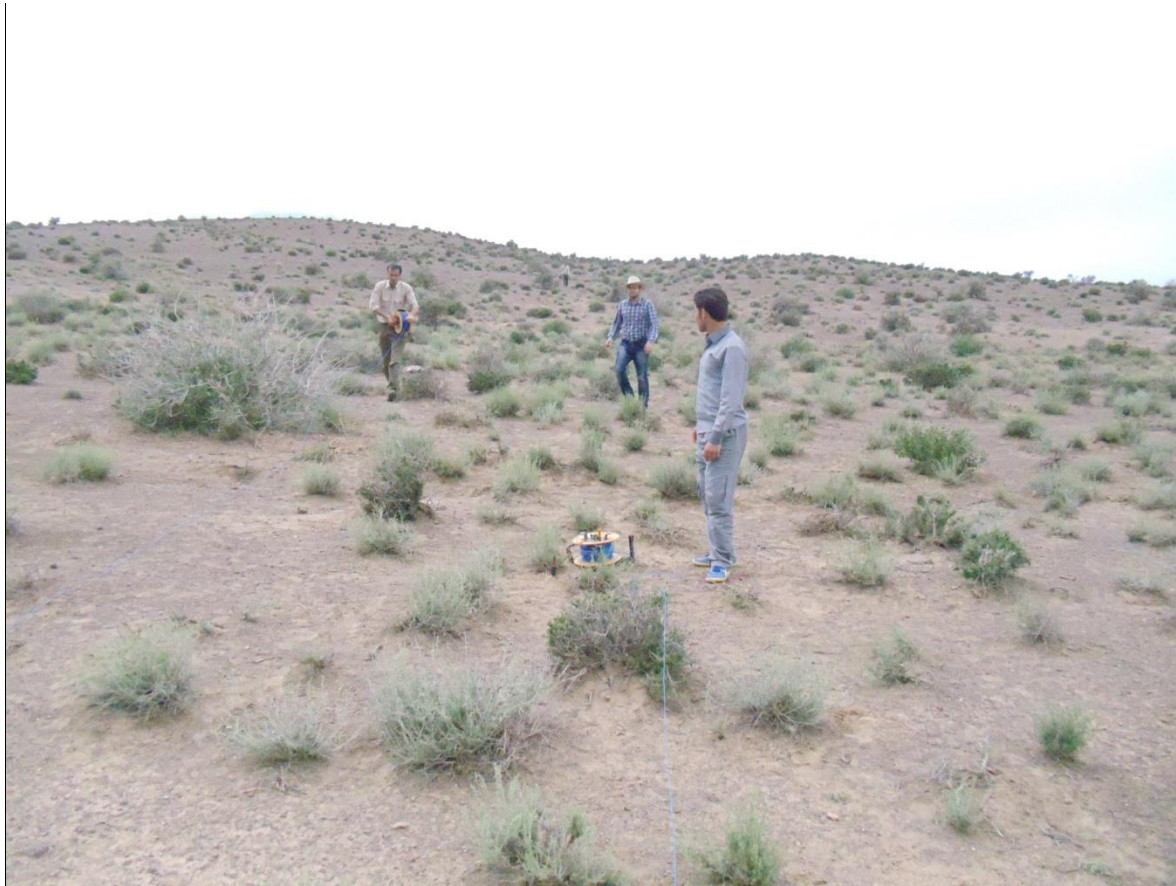
شکل ۱۱-۳: تیم اجرا در حال برداشت داده‌های مقاومت ویژه و IP.
