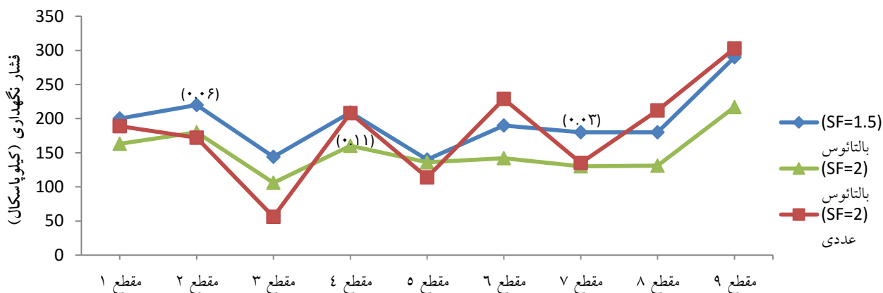
شکل ۳-۶. مقایسه نتایج روش عددی و بالتائوس (اعداد داخل پرانتز احتمال فاکتور ایمنی هستند در غیر اینصورت احتمال 0/1 است) در مقاطع مورد مطالعه
