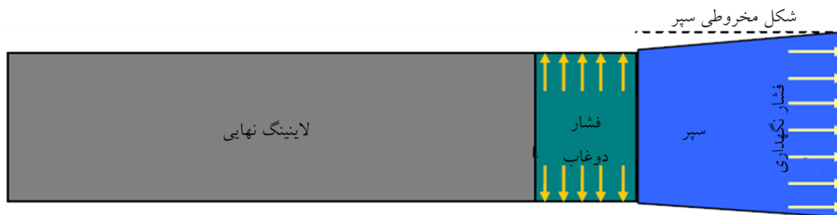
شکل ۵-۱. مراحل احداث تونل با سپر [20]
