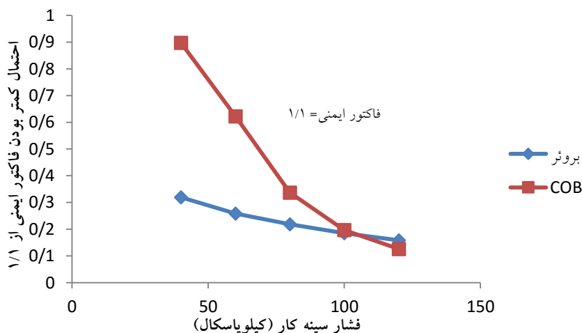
شکل ۴-۴۸. فشار نگهداری سینه‌کار در برابر ریزش و احتمال فاکتور ایمنی در مقطع ۶
