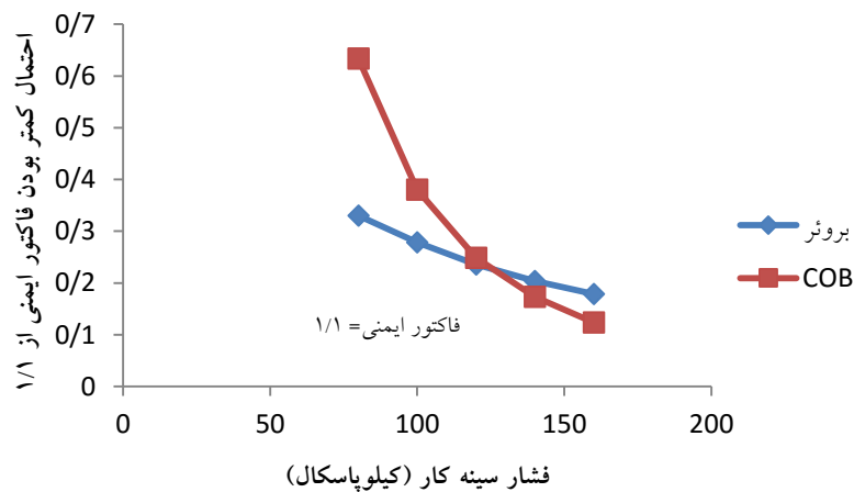
شکل ۴-۳۳. فشار نگهداری سینه کار در برابر ریزش و احتمال فاکتور ایمنی در مقطع ۳
