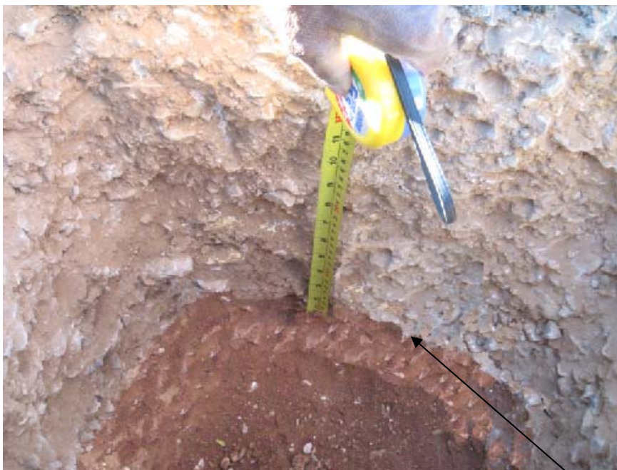
شکل ۳- ۱۱: ضخامت ۹ سانتی متری آسفالت در محل پروفیل شماره ۶.
