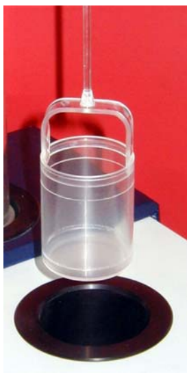
شکل ۳-۱۶- محفظه پلاستیکی برای اندازه گیری حساسیت مغناطیسی نمونه پودر شده.
