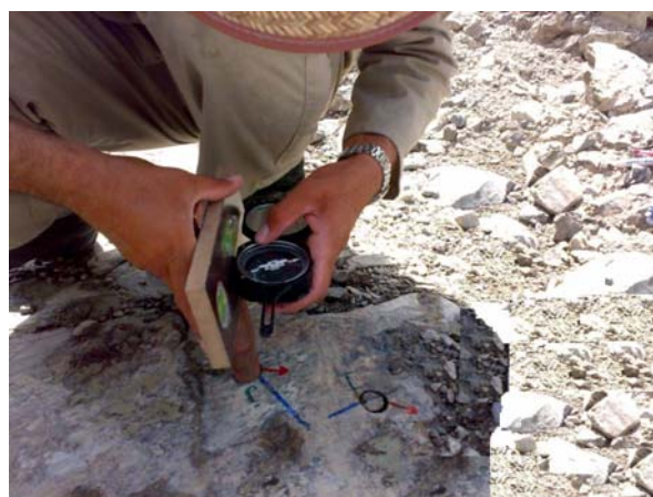
شکل ۳-۹- اندازه‌گیری شیب و جهت شیب مغزه به وسیله کمپاس.
