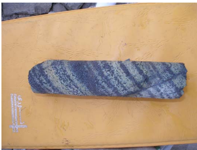
شکل ۳-۸- مغزه کرومیتی بدست آمده توسط دستگاه حفاری قابل حمل.
