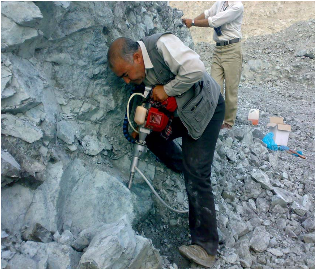
شکل ۳-۷- دستگاه حفاری قابل حمل، در حین حفاری سنگ دونیتی.
