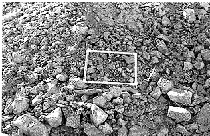
شکل ۳-۶- قرار دادن یک شی بر روی قطعات خرد شده در زمان عکس‌برداری (Palangio, 1999)
