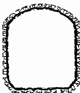
شکل ۴-۱۸ - منطقه شکسته شده حاصل از آتشباری ملایم با مواد منفجره گوریت به ابعاد 17 \times 50 میلی‌متر [۸].
