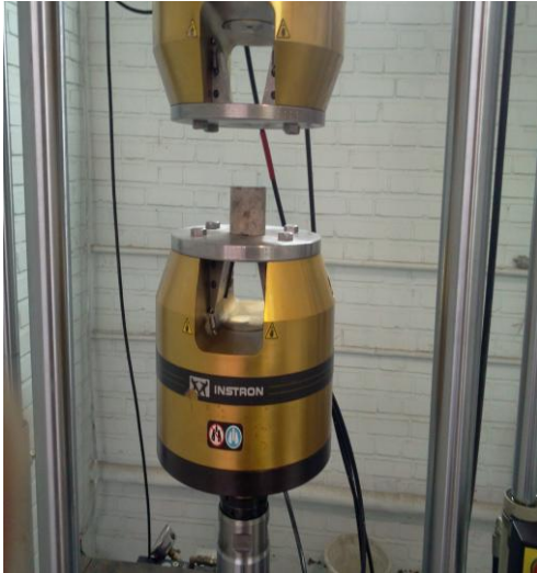
۲- شمایی از دستگاه بارگذاری مقاومت فشاری تک محوره
