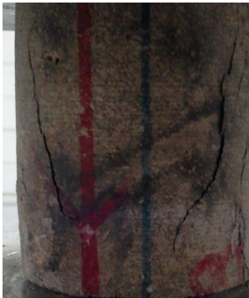
۴- نمایی نزدیک از نمونه بارگذاری شده تحت فشار تک محوره
