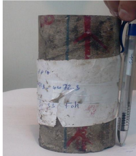
۱- نمونه مغزه استفاده شد برای تست مقاومت فشاری تک محوره
