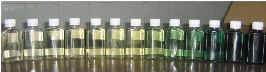
شکل ۲-۴ نمونه‌های گرفته شده از آزمایش لیچینگ؛ زمان نمونه‌گیری‌ها به ترتیب از چپ و طبق جدول ۱-۴ است
