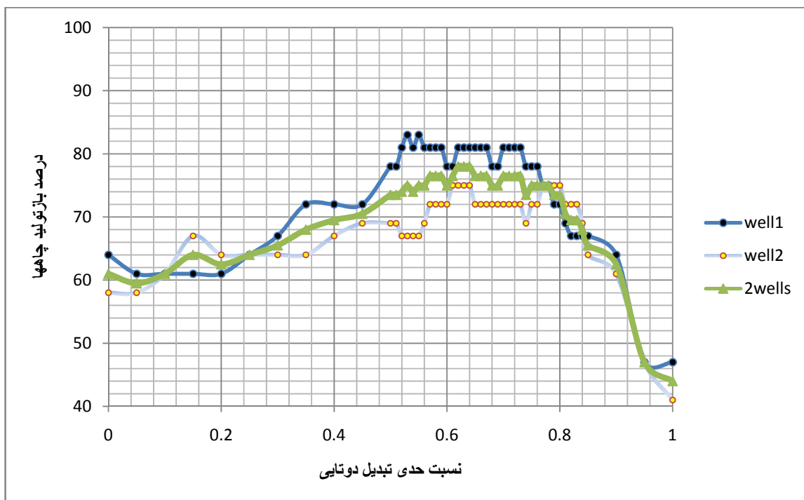
شکل ۶-۱۵ درصد بازتولید رخساره‌های صحیح چاه‌های مرحله اعتبارسنجی با تغییر نسبت حدی تبدیل دوتایی
