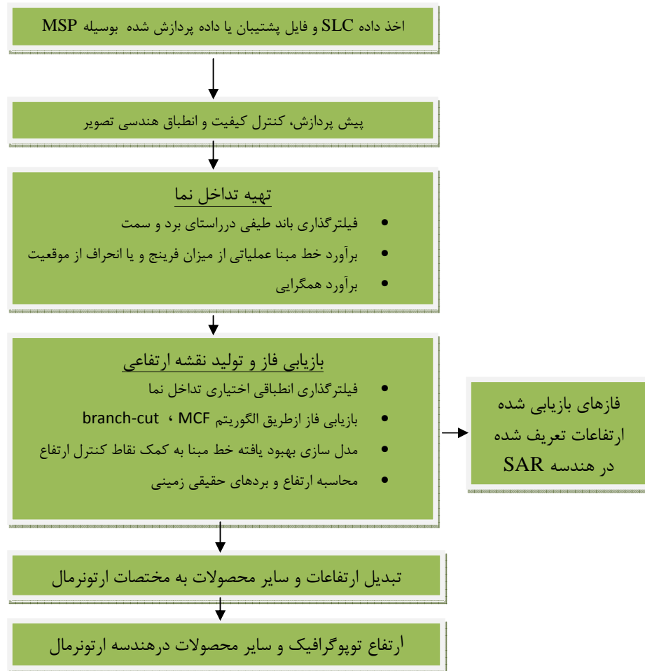
شکل ۴-۱۵ مراحل تشکیل تداخل نما در نرم افزار GAMMA (Wegmuller et al,2000)
