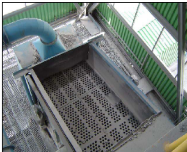
شکل ۳-۲- سرند لرزان دو طبقه واحد سنگشکنی (کریمی و همکاران، ۱۳۸۲)
