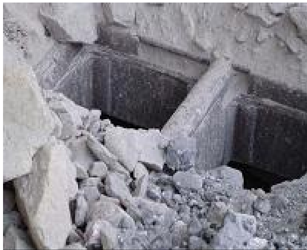
شکل ۳-۱- نمایی از گریزلی ابتدای واحد سنگشکنی (کریمی و همکاران، ۱۳۸۲)
