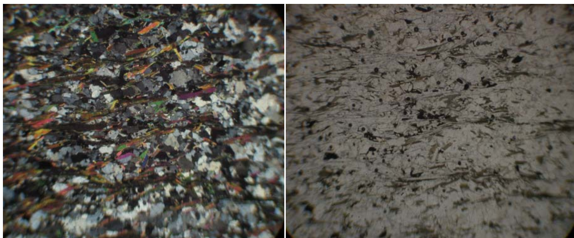
شکل الف-۲: در این دو تصویر کانی‌های فیلوسیلیکاته بیوتیت و مسکویت در بین بلورهای کوارتز در نورهای طبیعی و پلاریزه مشاهده می‌شوند
