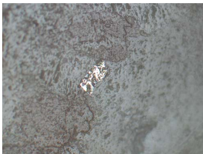
شکل الف-۳۱: تبدیل شدگی کالکوپیریت به اکسید و هیدرواکسیدهای آهن
