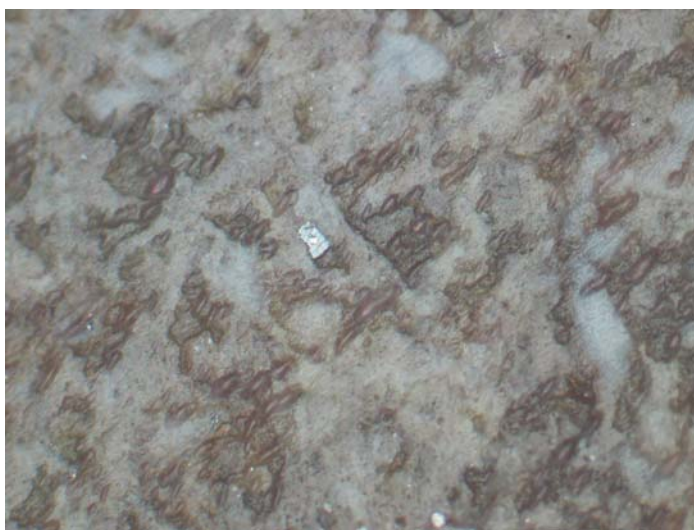
شکل الف-۲۶: قالب پیریت که از حاشیه به اکسید و هیدرواکسیدهای آهن تبدیل شده است
