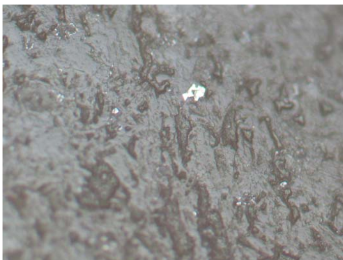
شکل الف-۲۳: حضور لکه های بی شکل کالکوپیریت و منیتیت در سنگ
