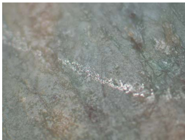
شکل الف-۳۲: پر شدگی رگچه‌ها توسط پیریت
