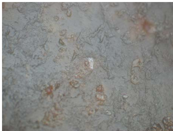
شکل الف-۲۱: حضور اکسید تیتان (در مرکز شکل) در سنگ
