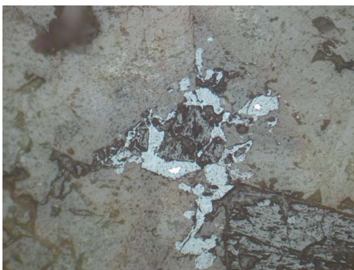
شکل الف-۱۶: تبدیل شدگی پیریت از حاشیه به اکسید هیدرواکسیدهای آهن
