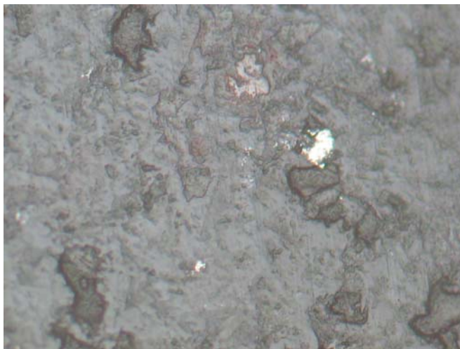
شکل الف-۲۲: حضور لکه های بی شکل کالکوپیریت در سنگ
