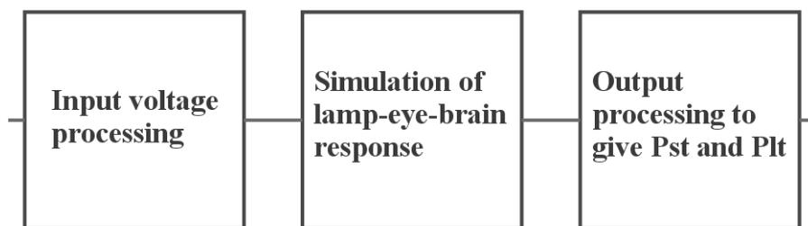
شکل ۲-۱۸: شمای خلاصه مراحل کار دستگاه
