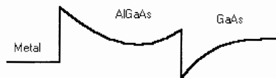
شکل (۳) - چاه پتانسیل مثلثی در HEMT
