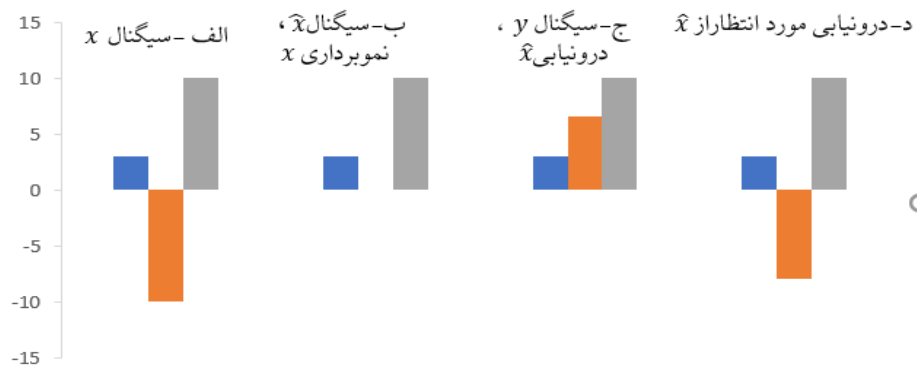
شکل ۱-۱: درون‌یابی از یک سیگنال دارای مؤلفه‌های فرکانس بالا
