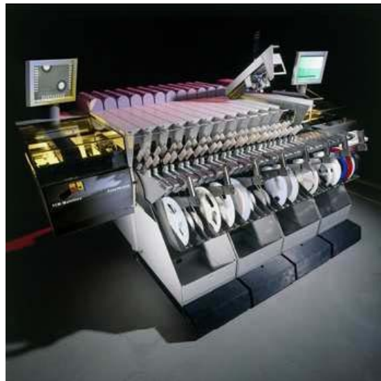
شکل ۴-۱: نصب کننده سریع قطعات دوازده بازویی
