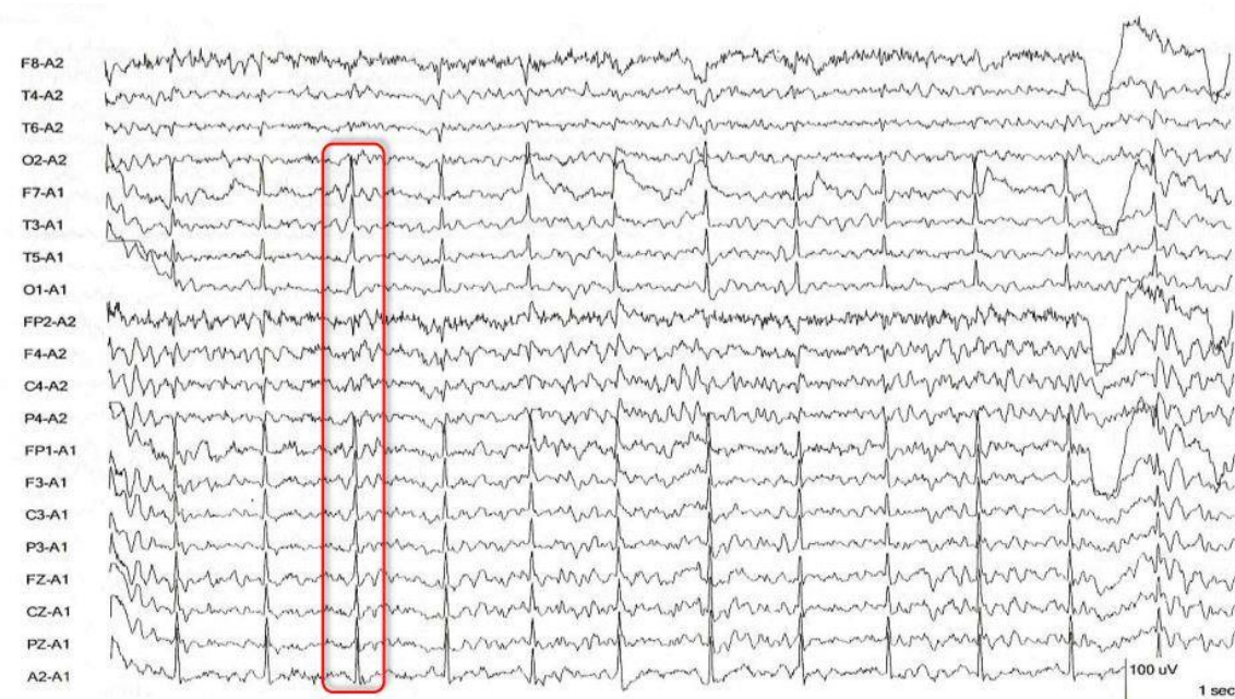
شکل ۳-۱۰: شناسایی نویز ECG بر روی سیگنال EEG در حالت ثبت مرجع [۲]
