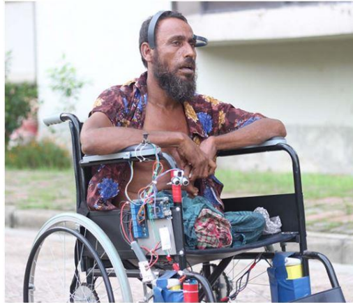
شکل ۲-۲: کاربرد عملی سیگنال مغزی در کنترل صندلی چرخدار [۴]
