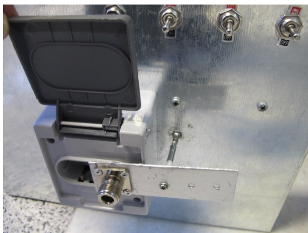
شکل (۴ - ۵) : نحوه قرارگیری آداپتور بر روی کانکتور EUT شبکه پایدارساز برای انجام کالیبراسیون
