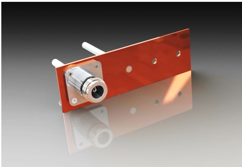
شکل (۴ - ۲) : مدل سه بعدی در نظر گرفته شده برای ساخت آداپتور متناسب با LISN ساخته شده
