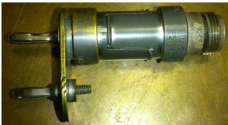
شکل (۴ - ۱) : یک نمونه ساخته شده از آداپتور اندازه‌گیری مشخصه امپدانس [۴۹]
