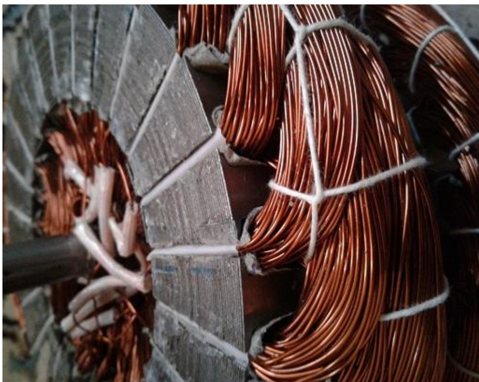
شکل (۱۳-۲): استاتور به همراه شیار و سیم بندی
