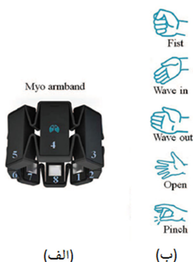
شکل ۲-۳۱ الف) دستگاه الکترومایوگرام ب) پنج حرکت تعریف شده در [۳۵]
