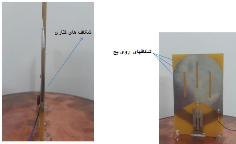
شکل (۳-۵) : نمایی از موقعیت آنتن و صفحه زمین
