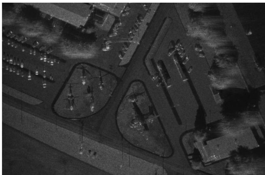
شکل (۲-۲) فیلتر لی اعمال شده بر روی تصویر SAR
