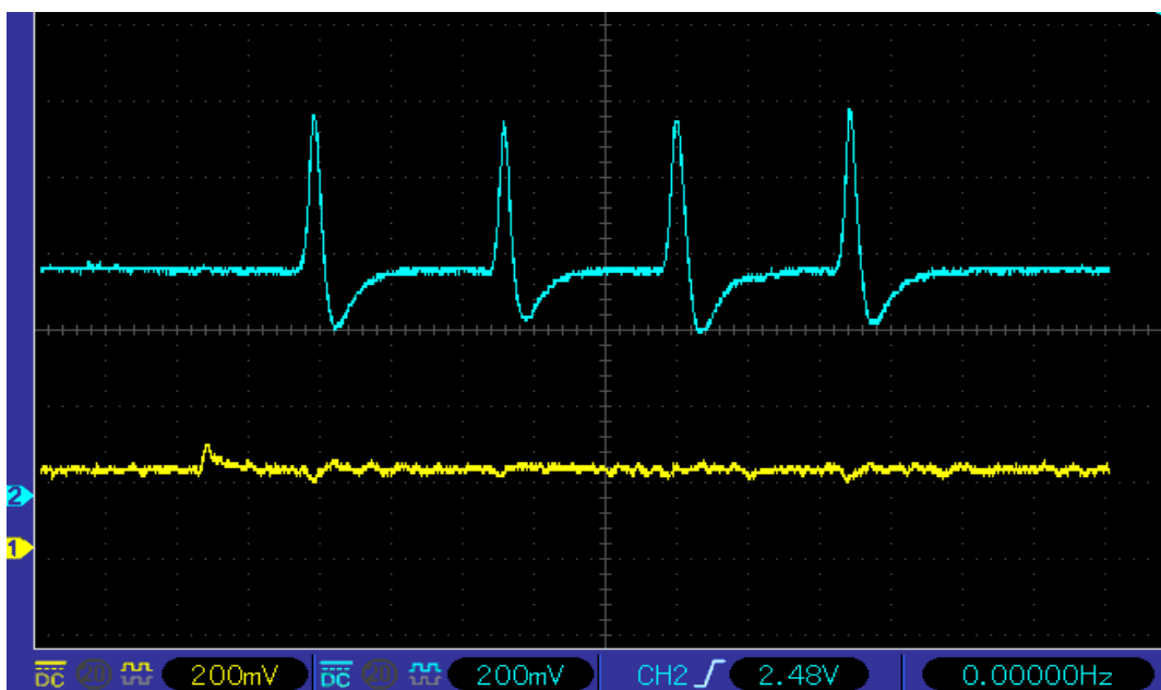
شکل ۴-۲۷: نمایش تأثیر پلک‌زدن بر روی کانال افقی
