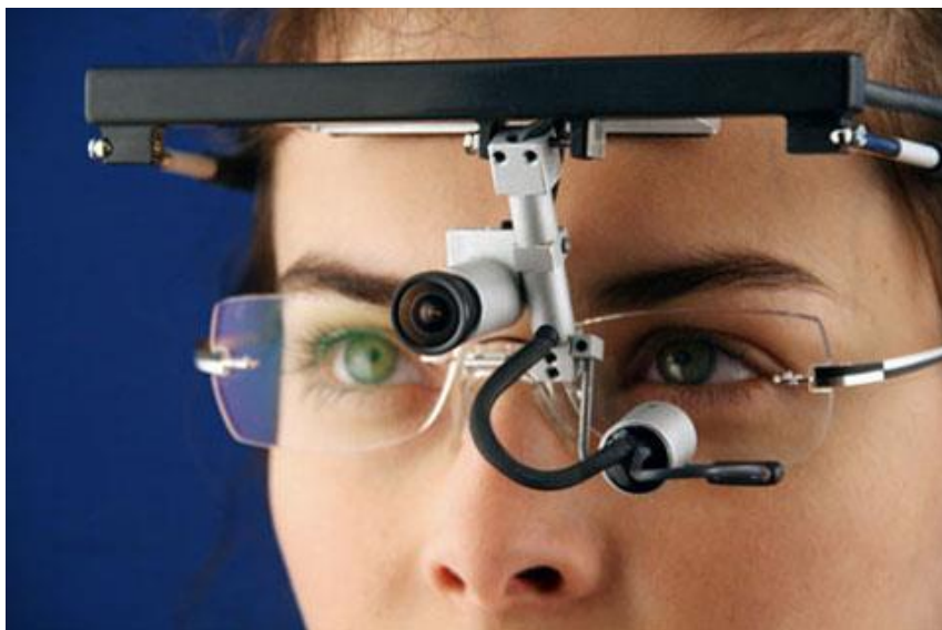
شکل ۳-۱۱: نمایشی از سیستم ردیاب چشم با روش پردازش تصویر [۴۰]
