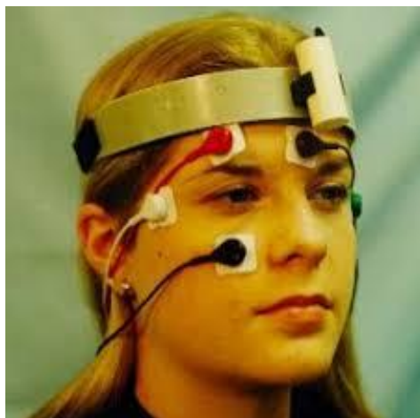
شکل ۳-۸: نمونه‌ای از اتصال الکترودهای متصل به اطراف چشم برای گرفتن سیگنال EOG
