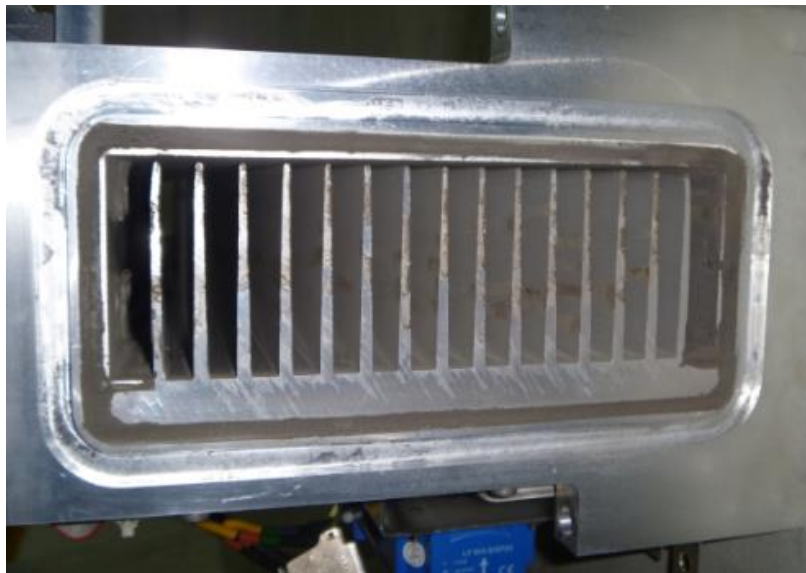
شکل A-۱۷- مجموعه هدسینک خنک‌کننده هوا igbt
