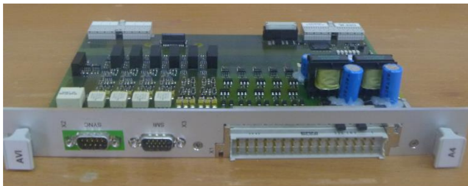
شکل A-۱۴- کارت AVI در مجموعه econ
