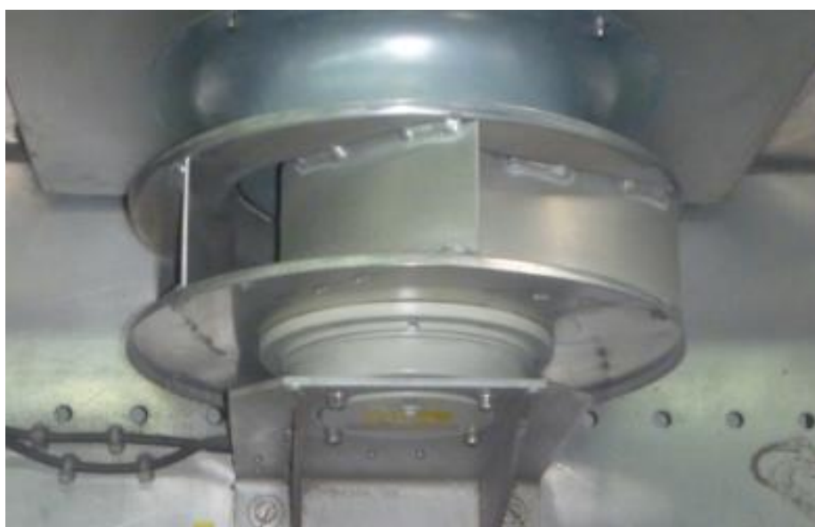
شکل A-۹- تجهیز فن در سیستم اینورتر ترکشن
