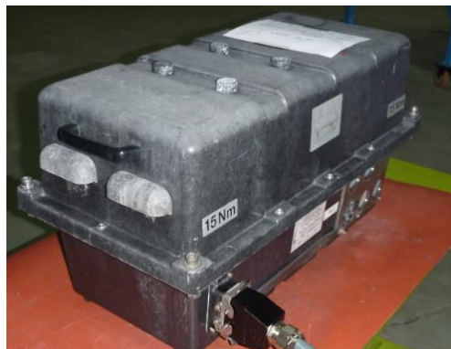
شکل A-4- تجهیز قطع کننده مدار کنترل بالا در سیستم اینورتر ترکشن
