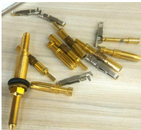
شکل A-۳۳- تصویر پین‌ها برای اتصال به کانکتورها
