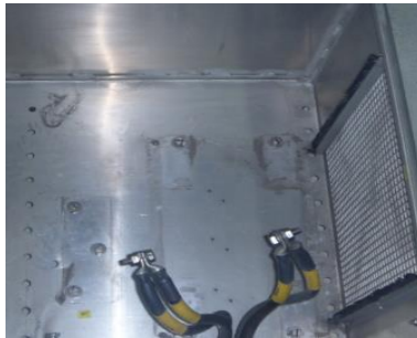
شکل A-39-دریچه خروجی در محفظه اینورتر ترکشن
