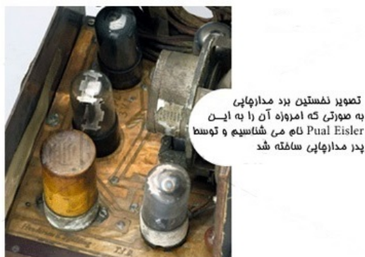
شکل ۱.۳: نخستین برد مدار چاپی
