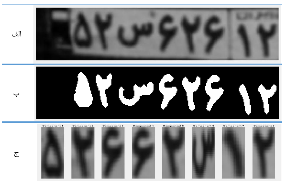
شکل ۲-۶ جداسازی اعداد و حروف با استفاده از روش واکاوی اجزای متصل (CCA). الف) تصویر پلاک، ب) تصویر
