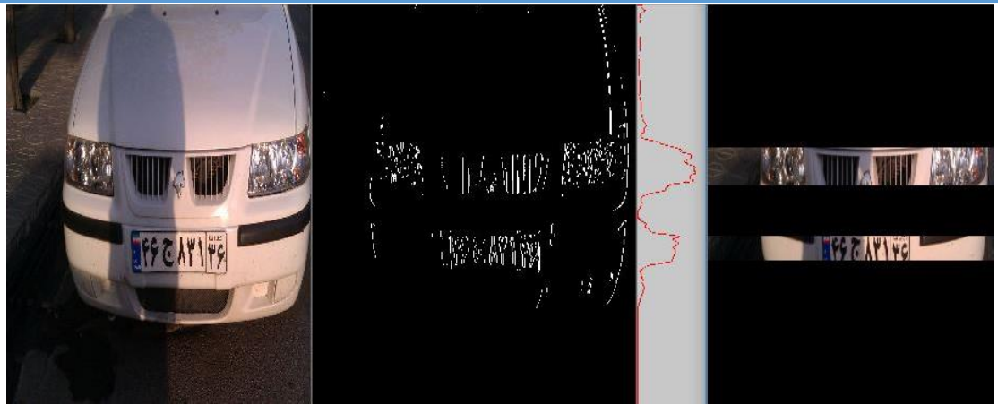
شکل ۷-۳ تأثیر اعمال افکنش به تصویری که پلاک در آن نسبت به افق زاویه ندارد
