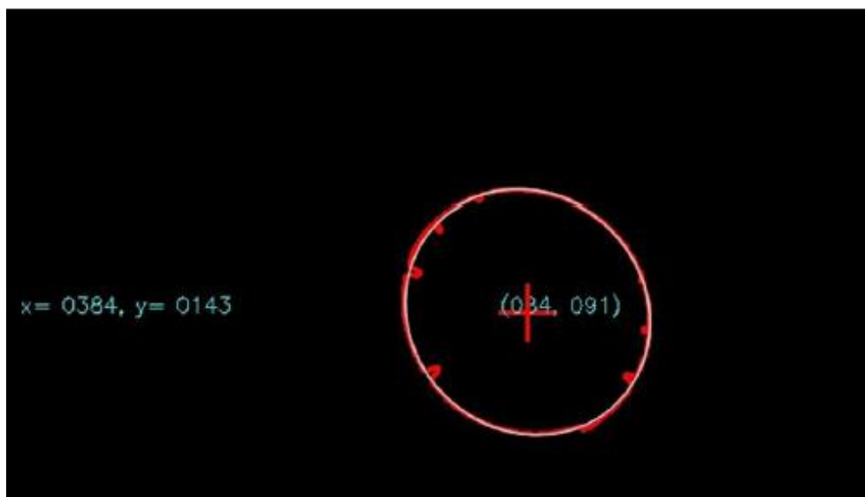
شکل (۲-۱۴): تشخیص مرکز نمایشگر آنالوگ
