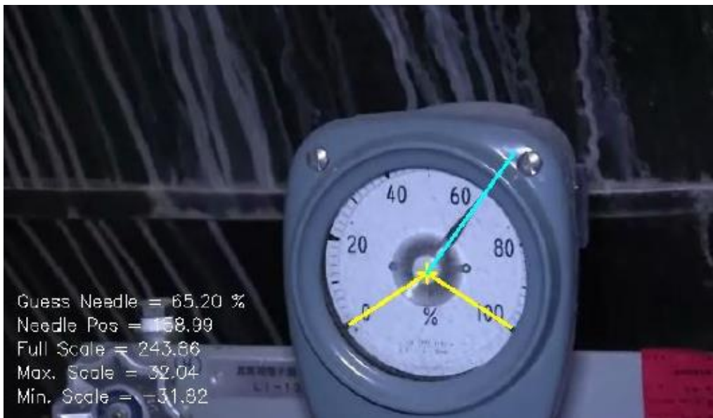
شکل (۲-۱۵): تشخیص مقدار نمایش داده شده توسط نمایشگر آنالوگ
