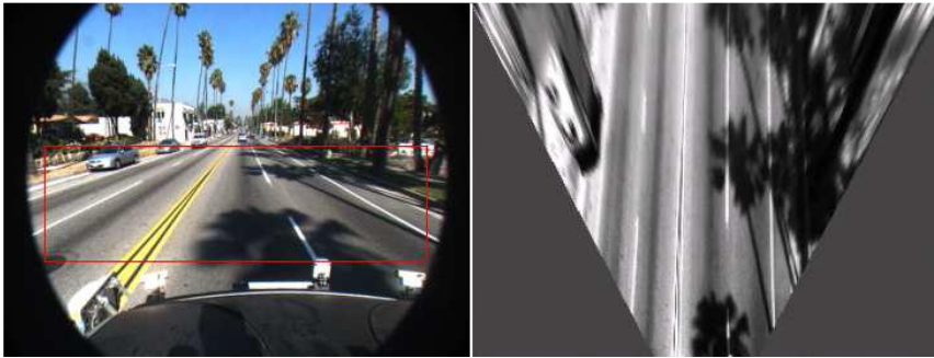
شکل ۳-۲: پرسپکتیو ساده، سمت چپ: تصویر ورودی با ناحیه مورد نظر در پنجره قرمز. سمت راست دید پرسپکتیو [16].
