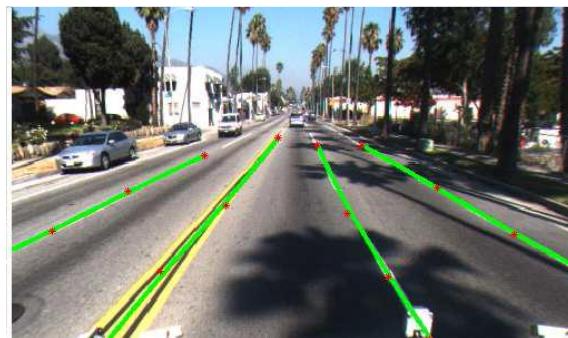
شکل ۲-۷: گام پس پردازش برای متمرکز کردن خطوط [16].
