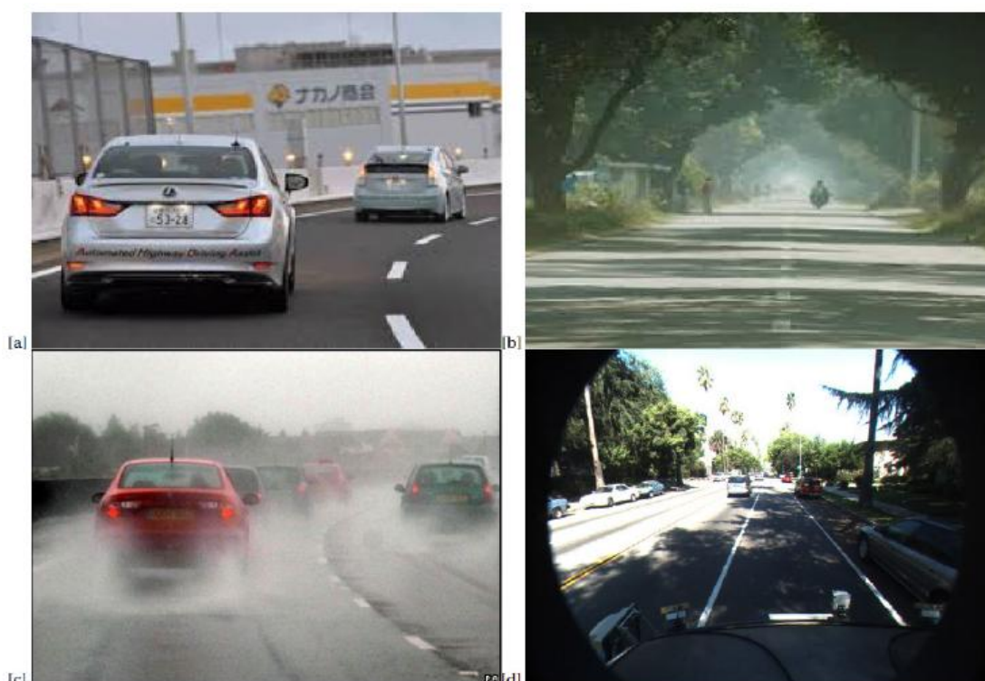
شکل ۱-۲ : چالش‌های مختلف در تشخیص خط. (a) مسدود شدن نشانگر خط توسط وسیله نقلیه جلویی، (b) درصدی از سایه، (c) جاده بارانی، (d) نهایت روشنایی در سمت چپ تصویر
