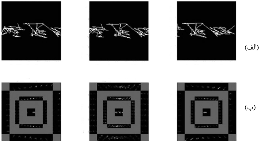
شکل ۴-۲. نتیجه اعمال تبدیل کرولت (الف): تصاویر سه بازه. (ب): تصاویر تبدیل کرولت هر سه بازه [۳]
