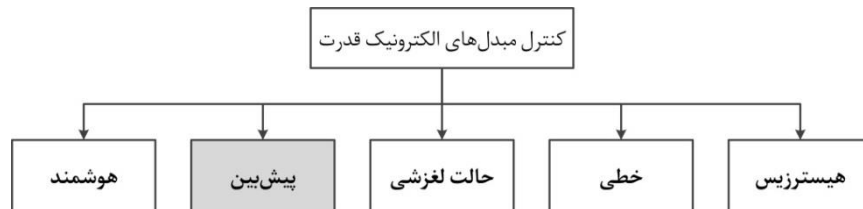
شکل ۳-۱: روش های مختلف کنترل مبدل های الکترونیک قدرت.
