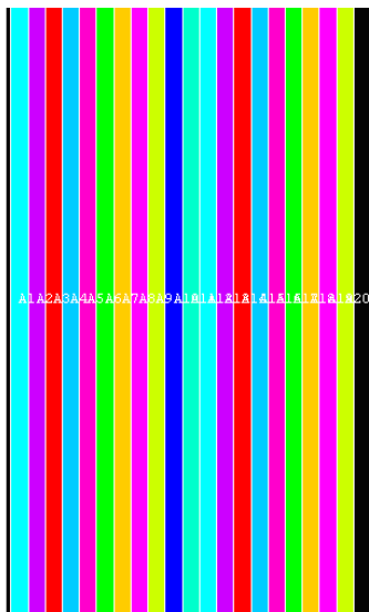
شکل (۵-۱) مدل مقطع طولی استوانه FGM با تقسیم به ۲۰ لایه
