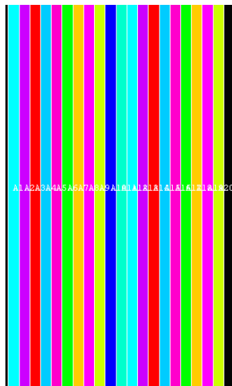
شکل (۲-۲) مدل مقطع طولی استوانه FGM با تقسیم به ۲۰ لایه
