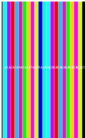
شکل (۴-۱) مدل مقطع طولی استوانه FGM با تقسیم به ۲۰ لایه
