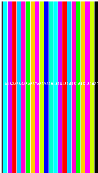
شکل (۳-۲) مدل مقطع طولی استوانه FGM با تقسیم به ۲۰ لایه
