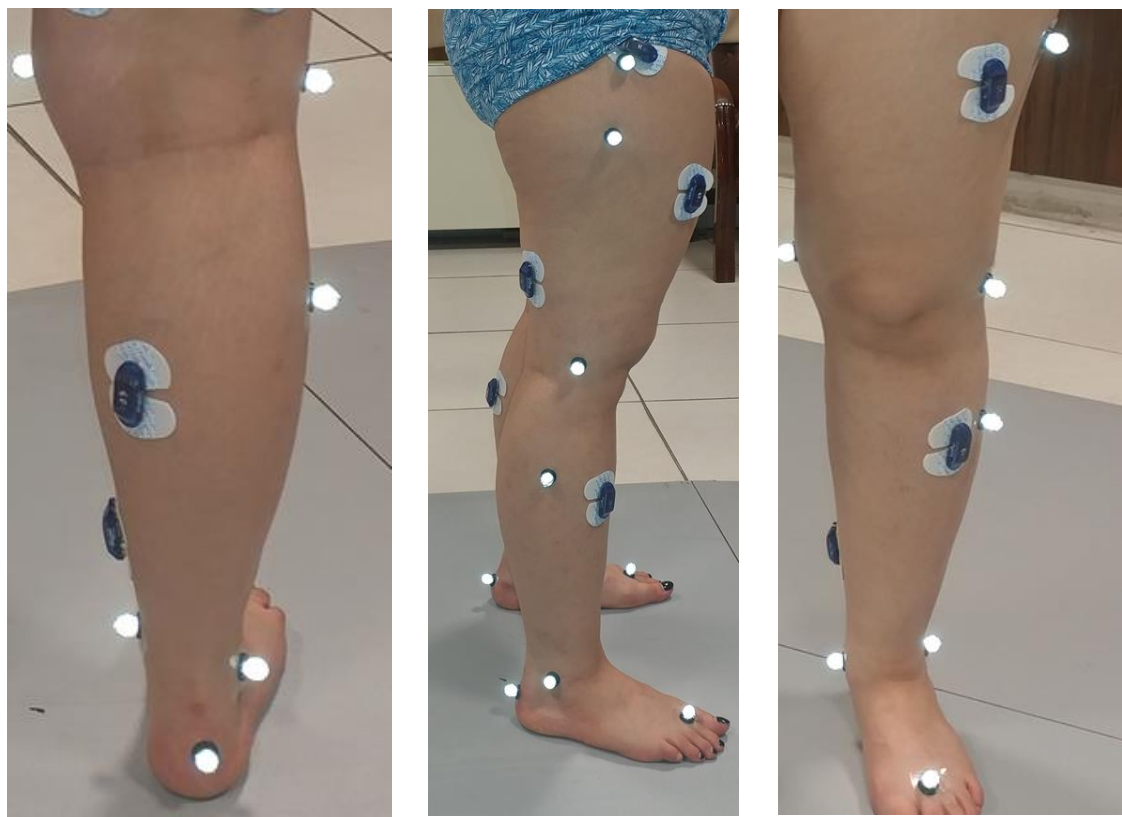
شکل (۳-۹) محل قرارگیری مارکرهای دوربین روی نیم‌تنه پایین جهت تحلیل گام برداشتن
