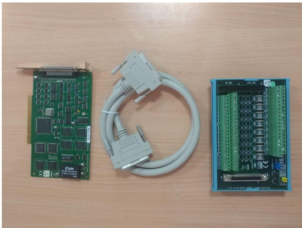
شکل (۹-۴) کارت انتقال داده Advantech PCI1710 به همراه برد ورودی و خروجی
