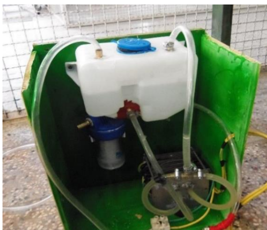
شکل ۱-۵ الکترولایزر تولید کننده گاز هیدروکسی به همراه تجهیزات جانبی
