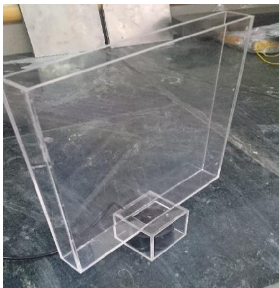
شکل ۱۰-۳ نصب ماژول آلتراسونیک در محفظه الکترولیز صفحه‌ای
