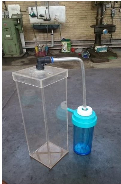
شکل ۳-۳ محفظه الکترولیز ساخته شده برای سلول استوانه‌ای و بابلر
