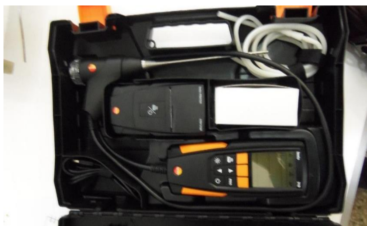
شکل ۳-۵ دستگاه تست گاز تستو مدل ۳۱۰
