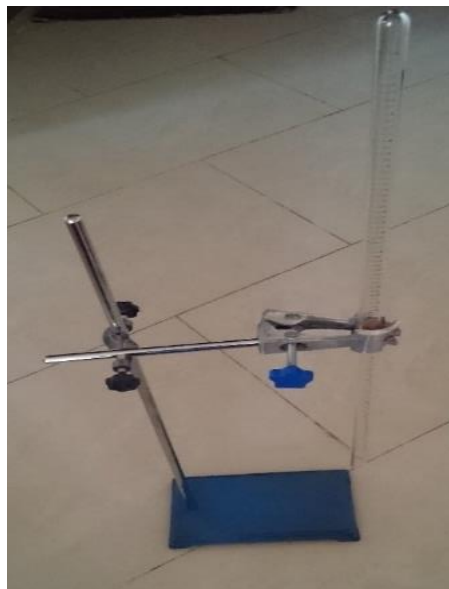
شکل ۳-۷ لوله گاز جمع کن مدرج استفاده شده در آزمایشها
