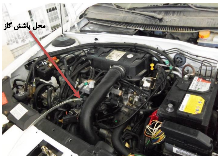
شکل ۲-۵ محل قرار گیری شیلنگ خروجی الکترولایزر در منیفولد هوای موتور
