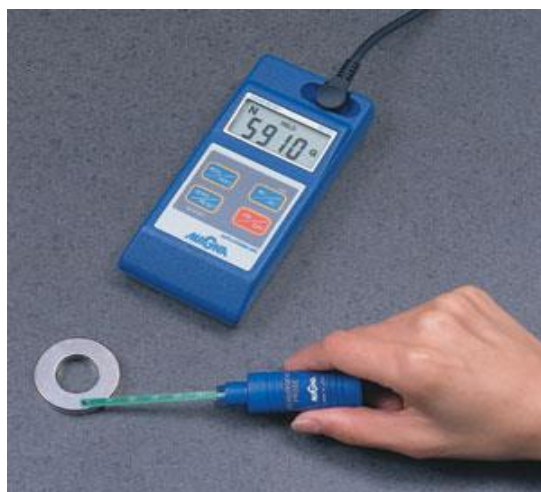
شکل ۳-۱۶ دستگاه تسلامتر مورد استفاده در آزمایش
