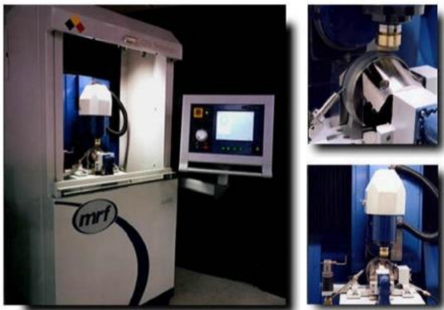
شکل ۱-۱۶: از فناوری‌های QED ، ماشین پرداخت کاری مگنتورئولوژیکال Q22 [۲۴]
