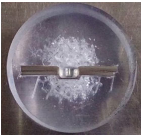
شکل ۱-۳: تصویر ماکروسکوپی نمونه آماده‌شده از اتصال سرد سوراخ‌دار ورق‌های DX51D/DOCOL 1400M
