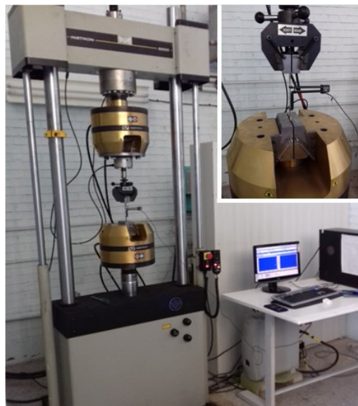
شکل ۳-۳: دستگاه آزمون کشش استاندارد، اینسترون ۸۸۰۲ سروهیدرولیک
