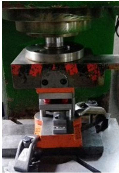
شکل ۳-۵: پرس هیدرولیک و ابزار مورد نیاز برای انجام اتصال سرد با قالب ثابت
