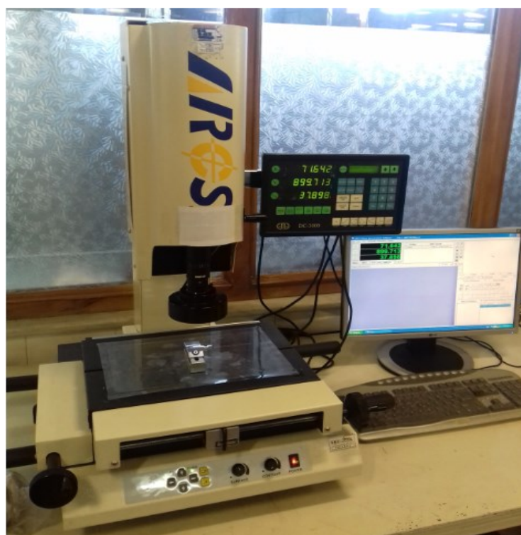
شکل ۳-۹: دستگاه سایه‌نگار برای اندازه‌گیری پارامترهای مقطع اتصال سرد
