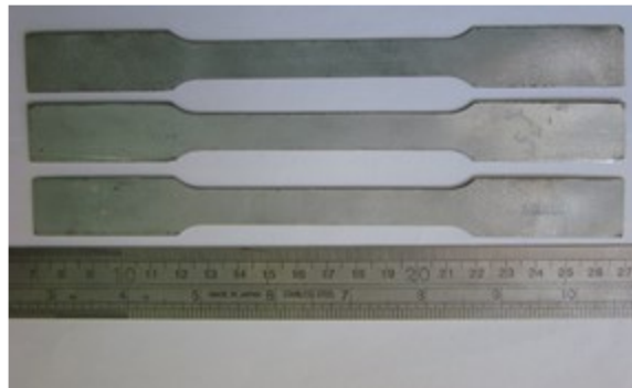
شکل ۳-۲: آماده‌سازی نمونه آزمون کشش بر اساس استاندارد ASTM-E8/E8M
