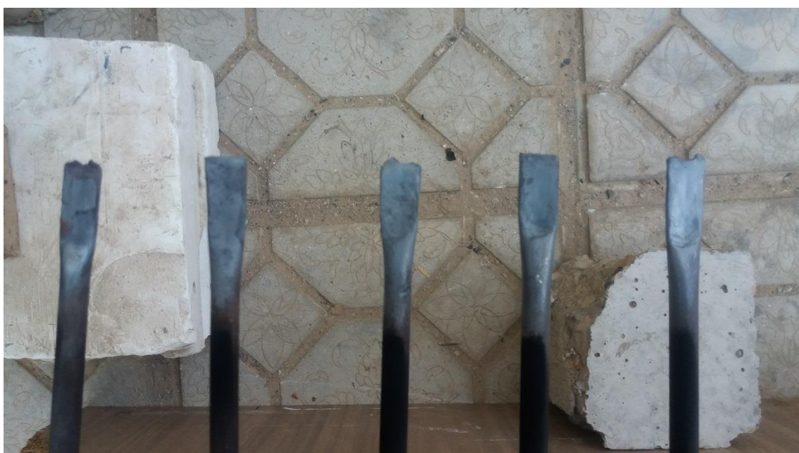
شکل (۴-۱۵): ایجاد یک لایه محافظ اکسید بر روی قسمت‌های زنگ‌زده
