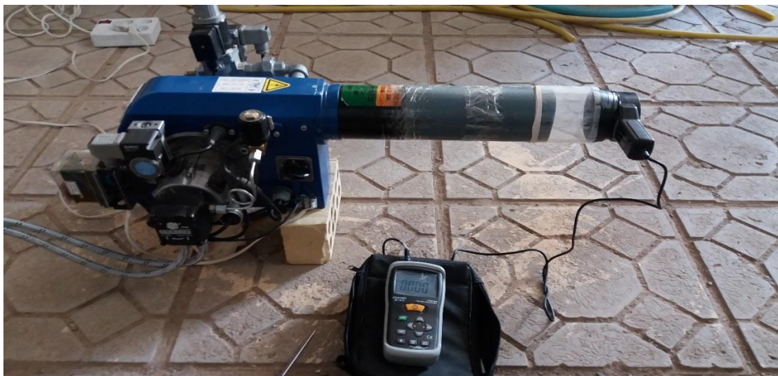
شکل (۳-۹): اندازه‌گیری دبی حجمی هوا توسط سرعت سنج
