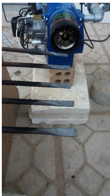
شکل (۴-۱۴): قرار گرفتن میله‌های آهنی در معرض شعله نانو سوخت اکسید آلومینیم
