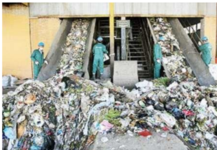
شکل ۴-۱: تصویری از تفکیک و سپس انتقال زباله‌ها به کوره‌های زباله [۷].
